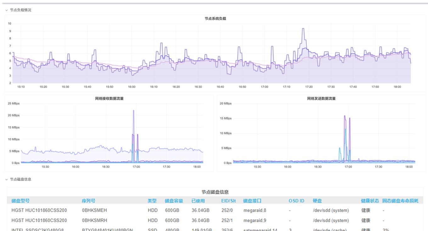
**节点系统负载**：节点系统负载是系统CPU繁忙程度的度量，即有多少进程在等待被CPU调度。图标左侧的数据单位是平均负载，即一段时间内系统的平均负载量，时间范围取1分钟、5分钟以及15分钟，您可以通过将鼠标移动到图表上方查看。
