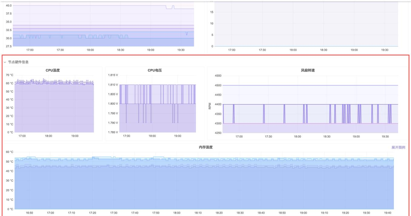
**CPU温度：**该图表监控了当前节点上每个CPU的温度。
