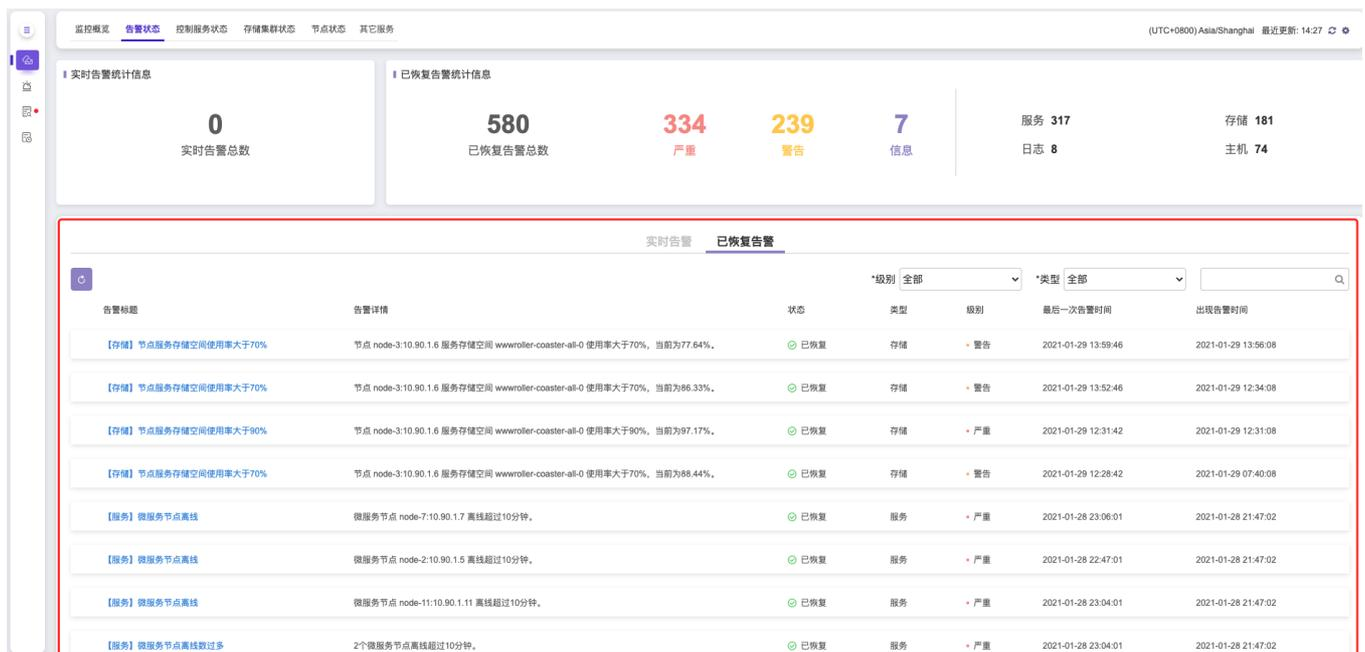
当集群中的某个服务触发了告警指标，您可以在 **告警状态** 页查看到告警内容，同时该服务状态也将会显示为多种对应的状态，如 **无数据**、**停止**、**警告** 等。例如：当您收到一条告警信息为消息队列停止服务时，告警级别为 **严重**。此时，您通过切换页面到 **控制服务状态** 页面，可以查看到该服务状态为 **停止**。
