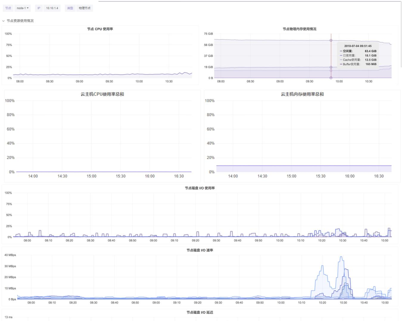
**节点CPU使用率:** 在 **节点CPU使用率** 图表中，您可以清晰查看到当前CPU的使用率，当使用率超过70%时，会触发级别为 **警告** 的告警通知：节点 node-x:IP CPU使用率大于70%，当前为xx%。当节点CPU的使用率超过阈值90%时，会触发级别为 **严重** 的告警通知：节点 node-x:IP CPU使用率大于90%，当前为xx%。
